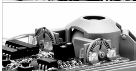
Abb. 1: Computermaus (Innenansicht), zu erkennen sind Kugel und x - y -Speichenrädchen
