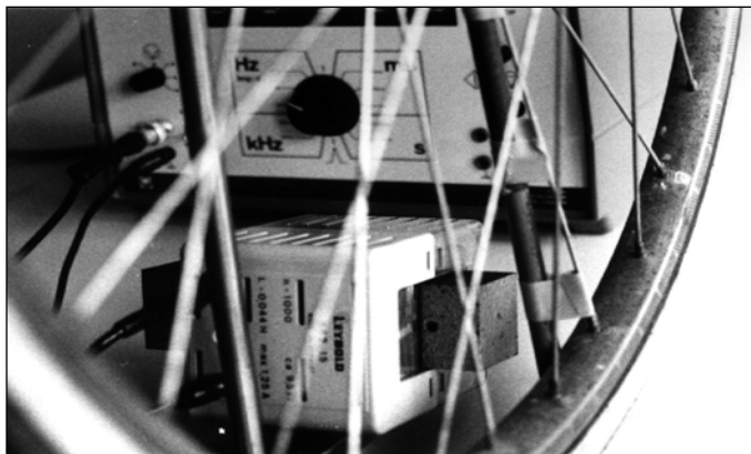
Abb. 1: Detailansicht mit Spule und Eisenkern sowie an einer Speiche befestigter Magnet
