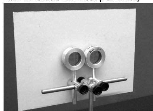
Abb. 4: Blende b mit Linsen (von hinten)
